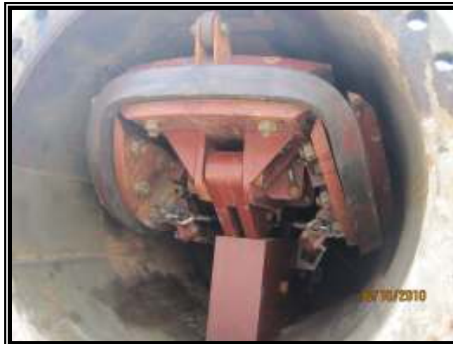
Rajah 24: Mesin line stopping yang siap dipasang di Jalan 17/1.
